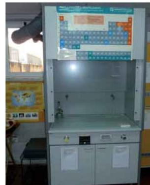
La buona efficienza della cappa si ha quando l'aspirazione (preferibilmente distribuita sia in alto che in basso) garantisce una velocità frontale dell'aria aspirata non inferiore a 0,5 m/s (valori riferiti a 40 cm di apertura del frontale).
