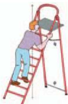
Scala doppia a gradini munita di piattaforma. Nella scala occorre mantenere una posizione di equilibrio stabile, quindi l'utilizzo della scala non va effettuato fino agli ultimi gradini.
